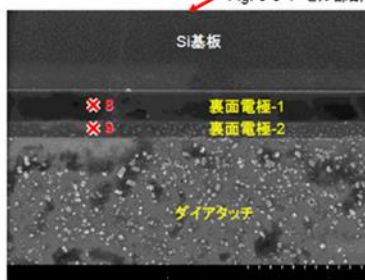
Fig. 3-3-5 表面断面SEM像(IGBT/FWD境界)
